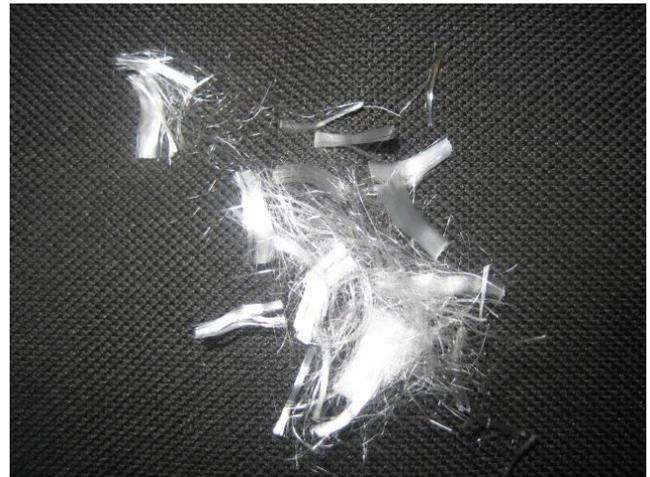
Las dosificaciones recomendadas en el caso del empleo de MasterFiber 022 en hormigón para proteger contra el fuego pueden ser variables según las condiciones de exposición y el nivel de protección especificado, con lo que se recomienda ajustar la dosificación de fibra a partir de ensayos previos representativos.
